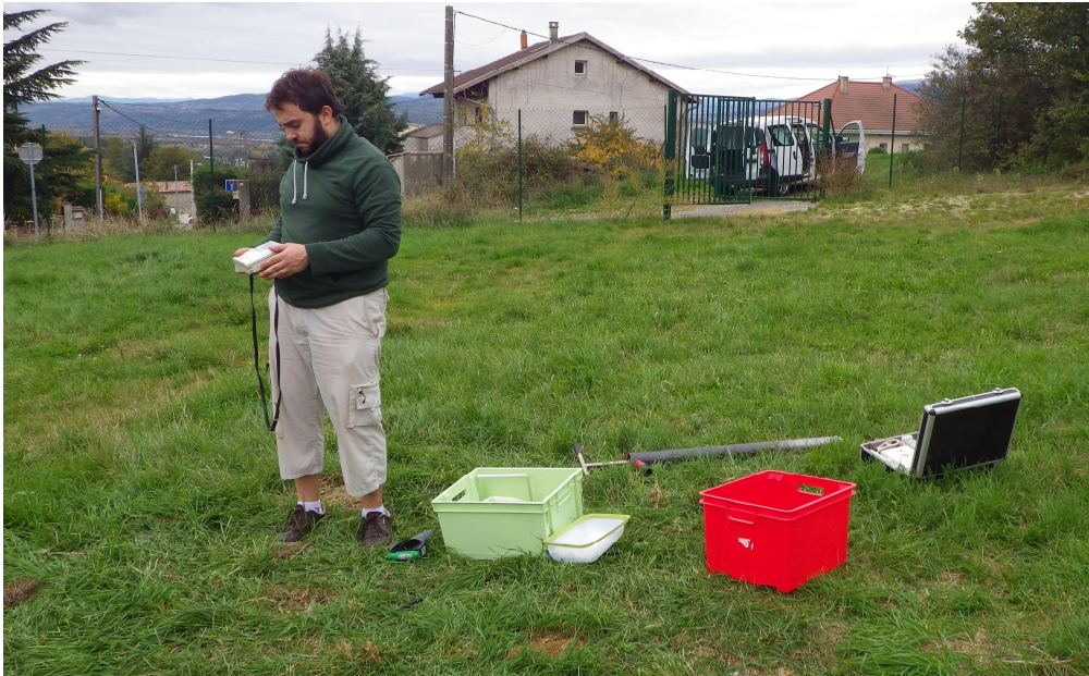
Photo 1 : Réalisation d'une mesure radiométrique à 1 m du sol au voisinage du carottage 3 points
